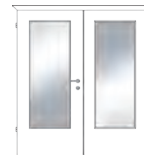
2-flügeliges Türelement (mit Gegenfalz und Kantriegel, optional mit Glaslichte)
